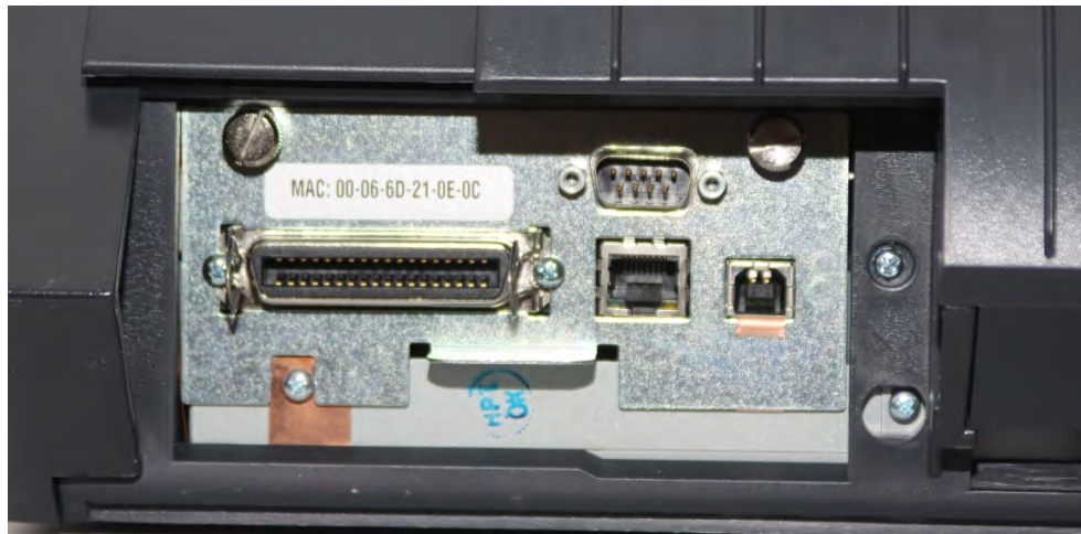
1 Drucker - 4 verschiedene Anschlüsse: parallel, seriell, Ethernet und USB
